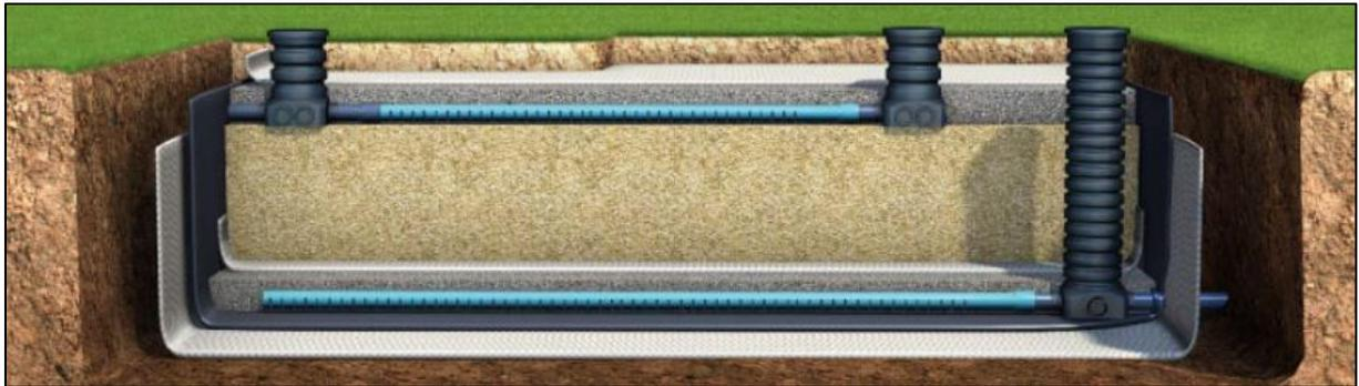
*Figure 5 : Schéma d'un filtre à sable vertical drainé*
