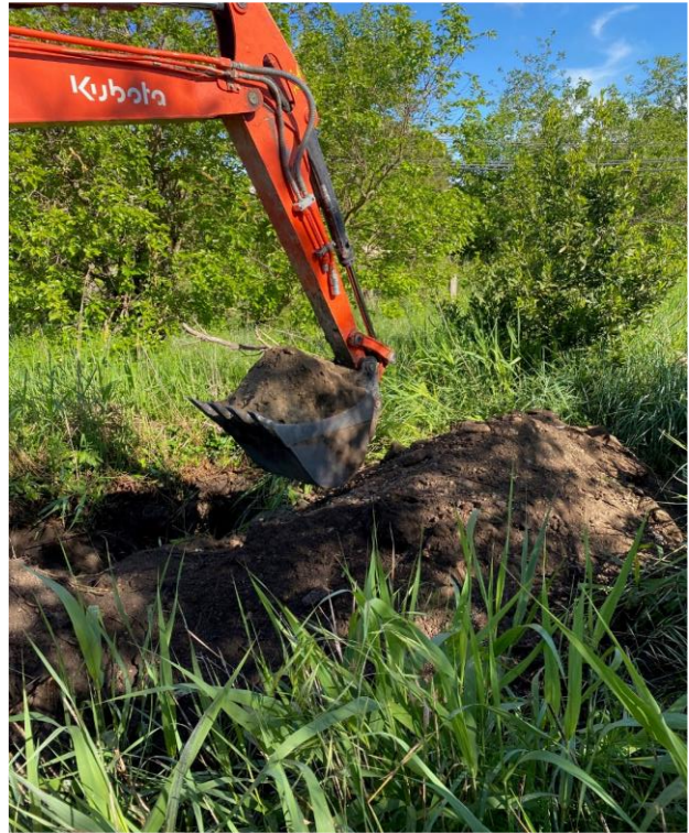
Reconnaissance lithologique à la pelle mécanique
