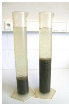
Fig 8 : Analyse par méthode du V30
