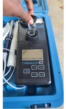
Fig 4 : Analyse de la turbidité
