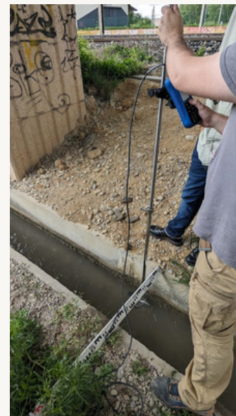
PHOTO D'UNE MESURE DE DÉBIT AU MICROMOULINET, DANS LE CANAL SAINT JULIEN À CHAVEL-BLANC
