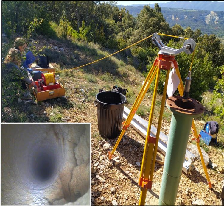
Ci-dessus : Prospection caméra et photo d'un potentiel drain karstique dans le forage BFS
